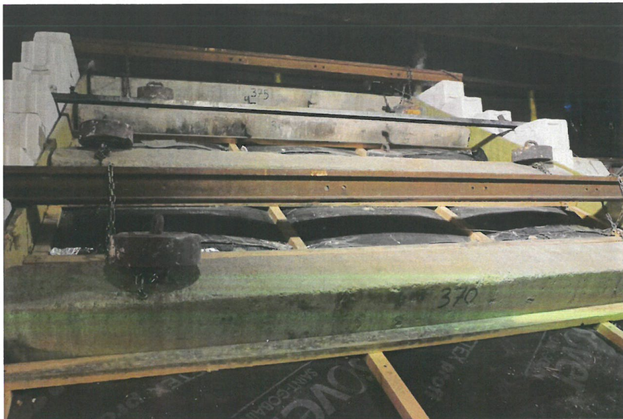
Rys. 10. Strona nienagrzewana elementu próbnego, t = 37m 16s
