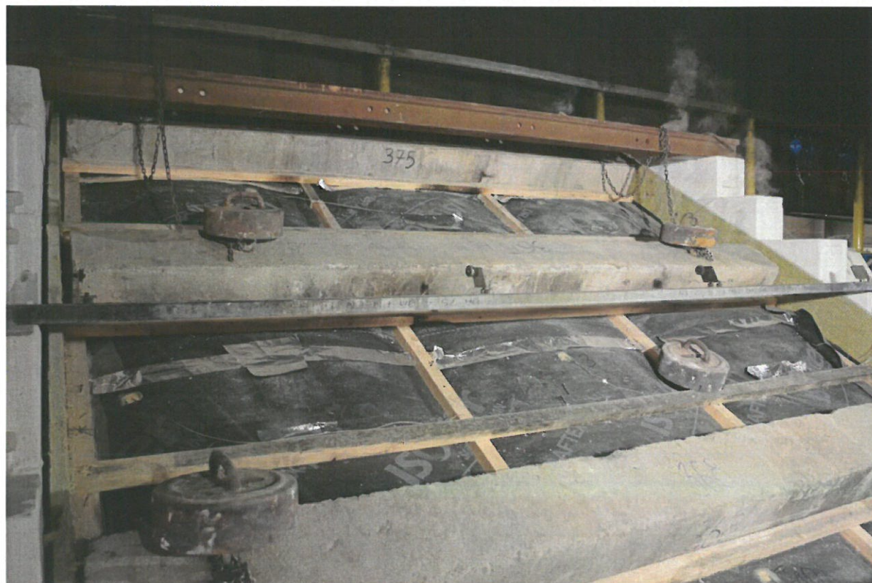
Rys. 9. Strona nienagrzewana elementu próbnego, t = 20m 40s
