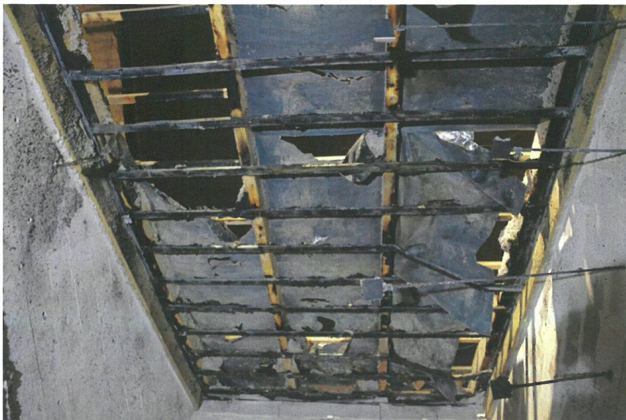
Rys. 16. Strona nagrzewana elementu próbnego po badaniu
