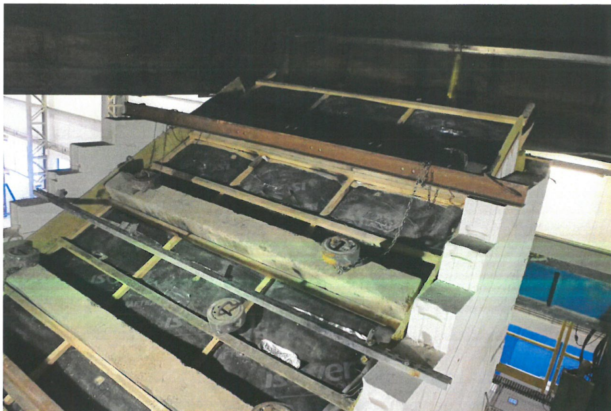
Rys. 15. Strona nienagrzewana elementu próbnego po badaniu
