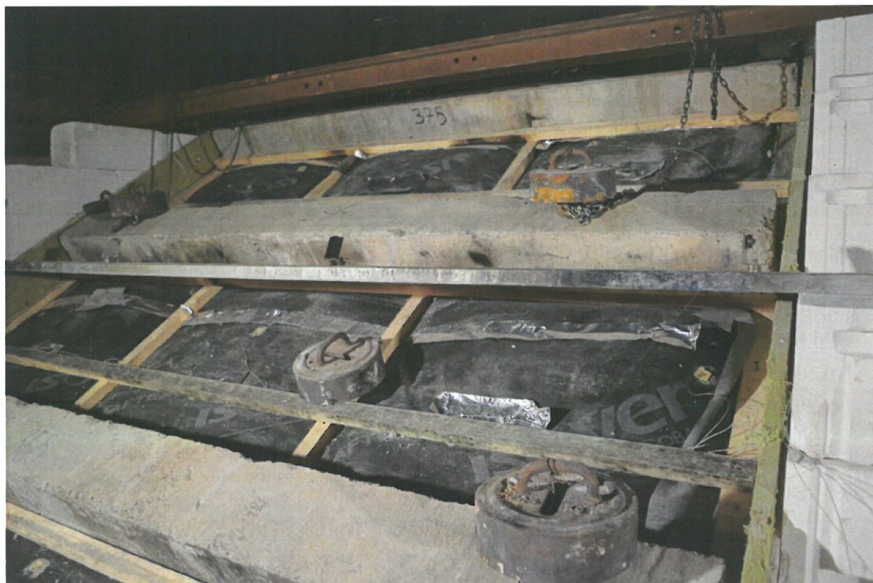
Rys. 1. Element próbny przed badaniem – strona nienagrzewana
