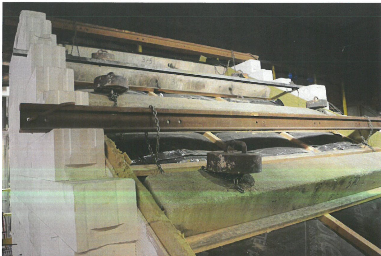
Rys. 8. Strona nienagrzewana elementu próbnego, t = 0m 28s
